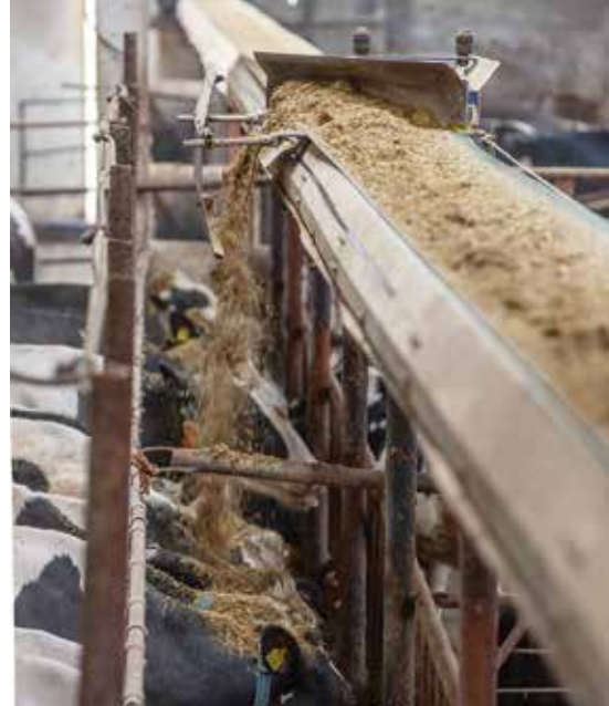
△ Pasza dostarczana jest zwierzętom za pomocą przenośnika taśmowego z pługiem, który zrzuca ją danej grupie zwierząt w określonym czasie i proporcji.
