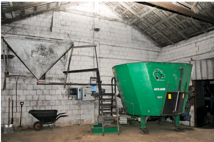
Pasze objętościowe mieszane są w stacjonarnym wozie paszowym o objętości 11 m 3 napędzanym silnikiem elektrycznym o mocy 18 KW. Obok mieszalnika jest kosz zasypowy na podstawową paszę treściwą.
